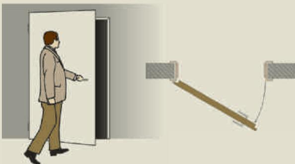
Sind die Bänder der geschlossenen Tür linker Hand zu sehen, ist die Tür links angeschlagen (DIN-L)
