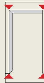
gemessen wird ab Oberkante des fertigen Fußbodens inkl. Estrich etc.
